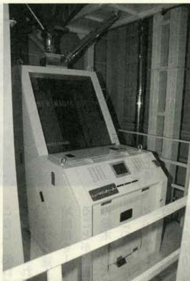
▲従来から使っていた色彩選別機に加えて導入されたガラス選別機マジックソーターRMGS281AMS
